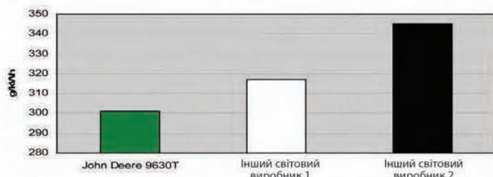
Таблиця порівняння витрат на паливо для тракторів серії 9630Т при максимальній потужності
