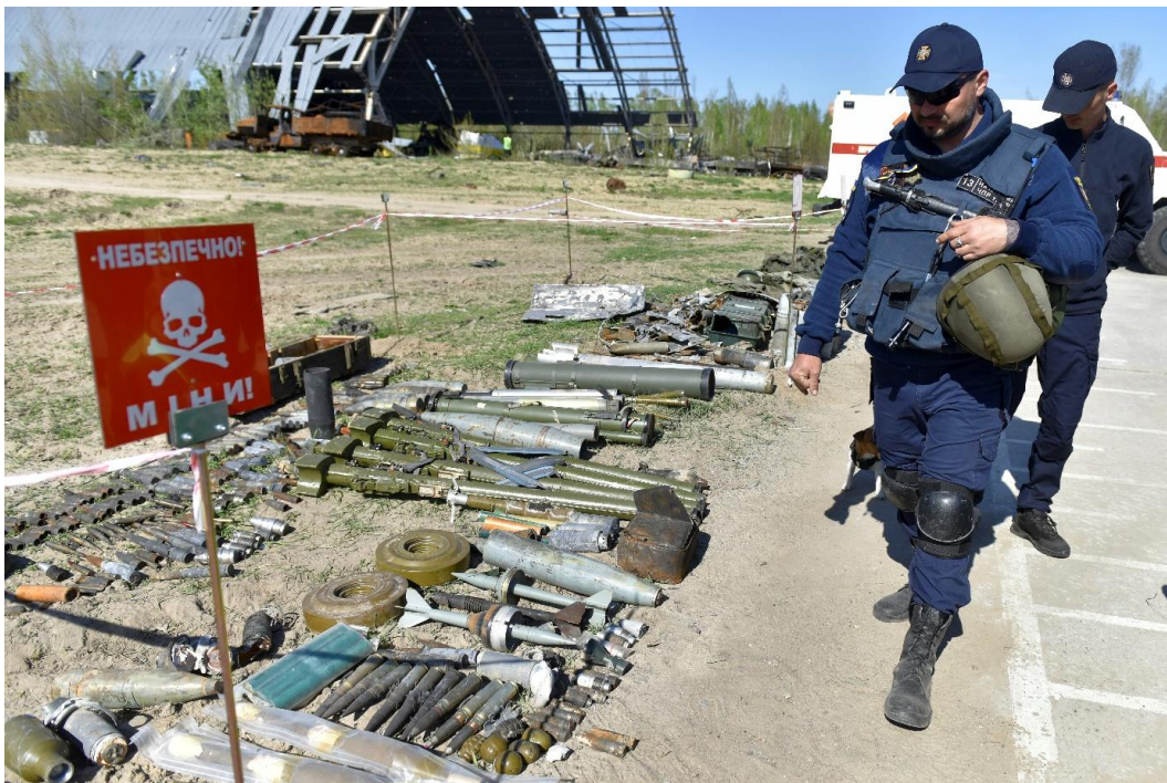
Abbildung 6: Feuerwerker des DSNS mit geborgenen Kampfmitteln, u.a. Rohrwapfenmunition verschiedener Kaliber, Flugabwehrhandwapfen, Panzerminen TM-62, Granatwerfermunition, Handgranaten u.a. (picture alliance / EPA / OLEG PETRASUYK).
