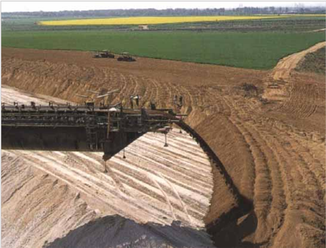
Abb. 5.2-3: Das Tagebauloch wird verfüllt und erhält an der Oberfläche eine ca. zwei bis drei Meter dicke Lößauflage. (Quelle: BezReg Köln)
